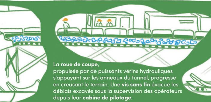
La **roue de coupe**, propuls  e par de puissants v  rins hydrauliques s'appuyant sur les anneaux du tunnel, progresse en creusant le terrain. Une **vis sans fin**   vacue les d  blais excav  s sous la supervision des op  rateurs depuis leur cabine de pilotage.
